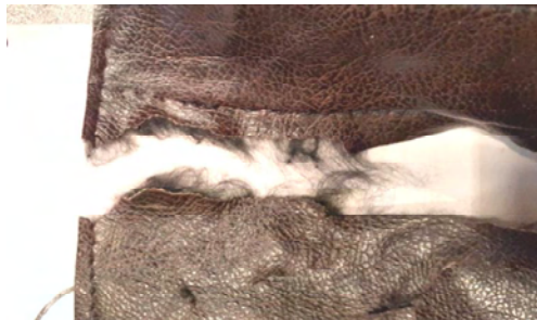
Рис. 10. Линия разрыва искусственной кожи на нетканой основе. Разрыв проводился руками в произвольном направлении
