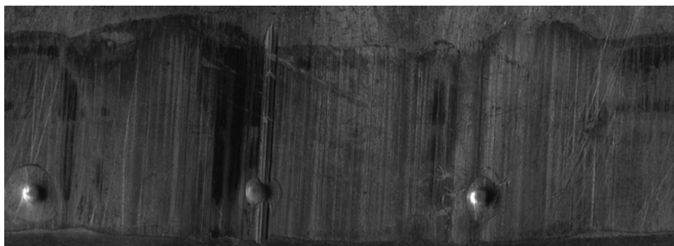
Рис. 1. Следы канала ствола на выстреленной пуле FMJ из карабина «ВПО-208» (Ланкастер) кал. .366 ТКМ
