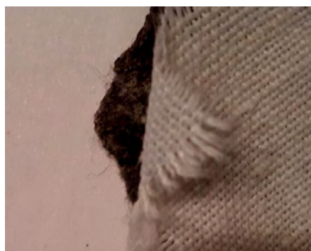
Рис. 9. Отслоение полимерного слоя от тканой основы при разрыве искусственной кожи. Направление приложения силы – между нитями утка и основы тканого слоя Эксперименты проводились по описанной выше методике в направлении приложенного усилия между нитями утка и основы тканой подложки
