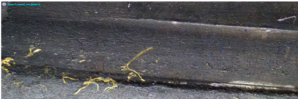
Рис. 3. След поля нареза на выстреленной пуле «ДЭРИ» из карабина «ВПО-209» (Парадокс) кал. .366 ТКМ
