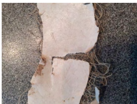
Рис. 8. Разрыв искусственной кожи по направлению приложения усилия между нитями утка и основы тканого слоя. Разрыв проводился руками от края материала, направление приложения усилия близкое к 45^\circ между нитями утка и основы
