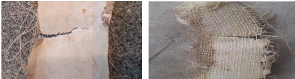
Рис. 7. Разрыв искусственной кожи по направлению приложения усилия, близкому к линии утка. Разрыв проводился руками от края материала, направление приложения усилия перпендикулярно нитям основы
