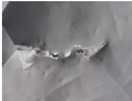
Рис. 2. Наложение линий разрыва пленочного материала (разрыв пленочного материала осуществлен руками от края)
