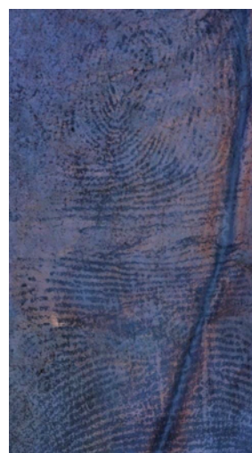
Рис. 4. Потожировой след пальца руки, выявленный парами цианакрилата на внутренней поверхности перчаток и контрастированный раствором черного судана
