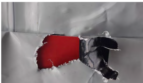
Рис. 6. Разрыв пленочного материала после достижения линии шва
